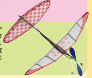
ライトプレーンと比較して、高学年向けのキットを製作します。接着剤で紙を貼り付け翼を作成します。遠くに飛ばすには、翼の位置等の調整やゴム動力の基礎も必要です。
